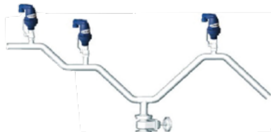
Eğimin arttığı-azaldığı noktalarda Çift Yönlü Vantuz
